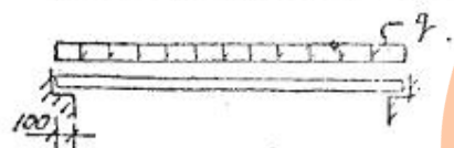
Схема опирания панели
